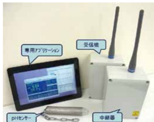
【無線伝送式pHセンサー】 岩手大学と山形東亜DKK(株)が開発
